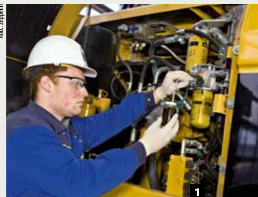
1 Alle im Rahmen des Condition Monitoring gesammelten Daten laufen bei Zeppelin auf, werden dort gesammelt, strukturiert und ausgewertet. Ein weiterer Baustein des Condition Monitorings ist die Diagnose von Öl und Kühlmittel von Baumaschinen.
