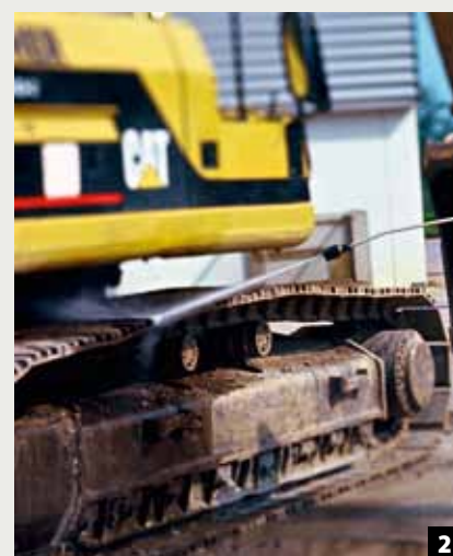
2 Festgetrockneter Dreck kann Kettenlaufwerke blockieren. Um ihre Funktionsfähigkeit zu gewährleisten, müssen sie regelmäßig gereinigt werden, auf der Baustelle jedoch ohne Zugabe von Reinigungsmitteln.
