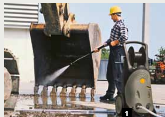
1 Mit dem energiereichen Wasserstrahl des Hochdruckreinigers können Stellen gereinigt werden, die von Hand mühsam zu reinigen wären. Die Baggerschaufel verträgt auch den Punktstrahl.
