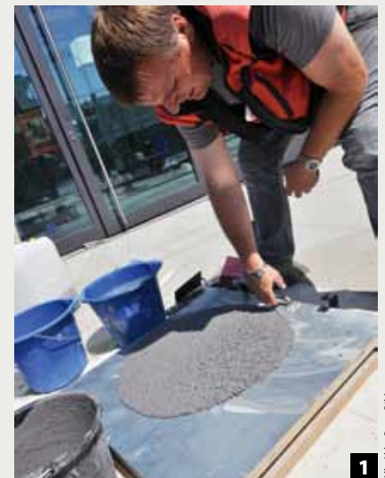
1 Prüfung des Ausbreitmaßes
