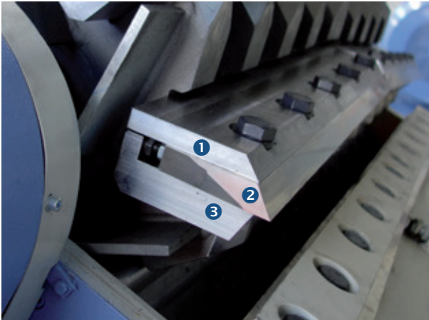
Abb. 3: ① Messerdruckleiste ② Rotormesser ③ Auswechselbares Verschleißteil.
