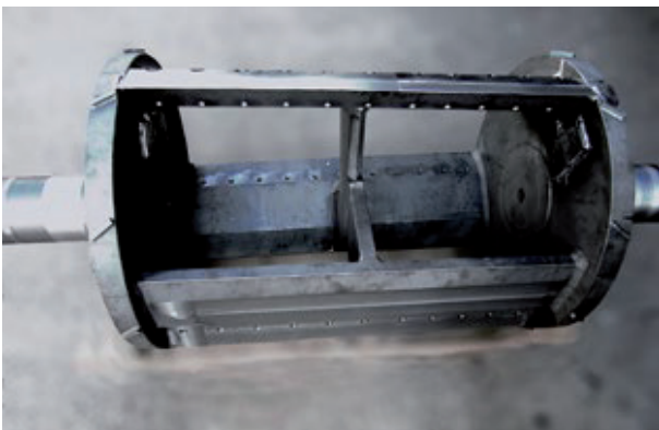
Abb. 1: Der Guillotinerotor ohne durchgehende Rotorwelle mit Abstreifern zwischen Gehäusewand und äußerer Rotorscheibe.
